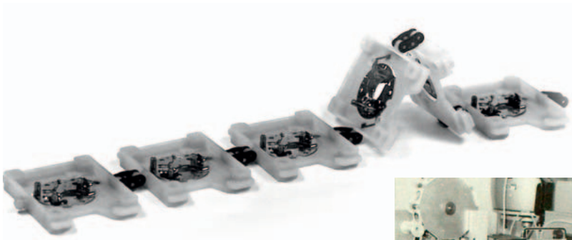
Bild oben: Werkstückträgerkette mit eingesetzten Werkplatten. Die Kette war mit Kugelgelenken verbunden, die ein Wenden ermöglichten.
