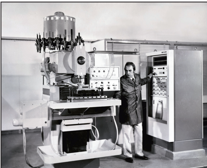
Das Bearbeitungszentrum FUW C 450 NC mit Bahnsteuerung
