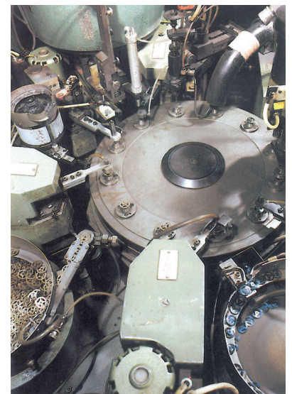
Die Montagestation des Räderwerkes, in der die vier Laufwerkkräder in Eingriff gebracht und in die Werkplatte eingesetzt wurden.
